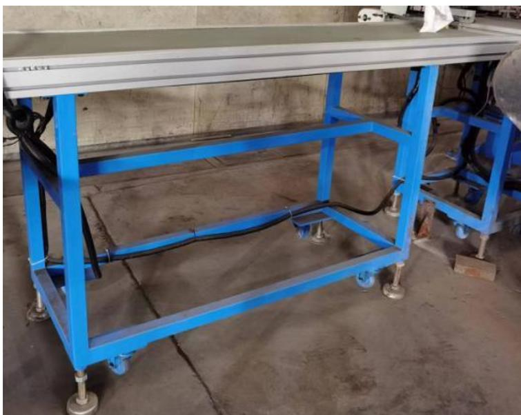
2.4.1、输送带的主要受力件采用了结构钢和 铝型材制作，皮带为  $\delta 3.0\text{ mm}$  的 PVC 材料，调速为安川变频器。具有刚性好、不易变形、传动平稳、速度可调、耐油耐温等的优点。（如上图）
