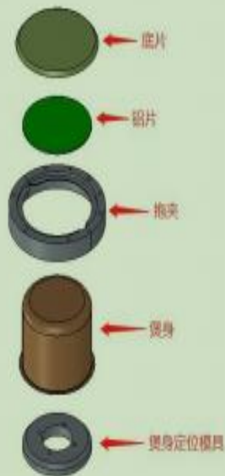
煲身、铝片和底片点焊拆分示意图
